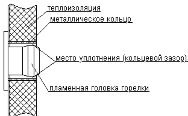
Рис. 3. Фрагмент фронтальной крышки котла (уплотнение зазора между крышкой и пламенной головкой).
